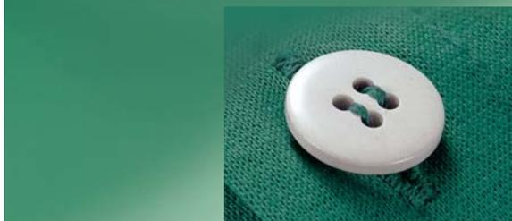
La función semi o completamente automática de las máquinas de coser botones requiere muy buenas características de la aguja de coser. La aguja tiene que guiar al hilo a través de los agujeros del botón y penetrar en ellos, que se vuelven más estrechos con cada puntada. Cuando la aguja toca el borde del botón, ha de ser introducida en el agujero en ese mismo instante. Si ésto no sucede, aparecen los siguientes problemas.
