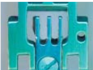
2. DAÑOS EN LA GARGANTA DE LA PLANCHA DE AGUJAS
