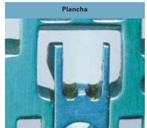
PLACA (PLANCHA) DE AGUJAS DAÑADA
