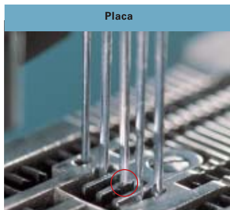
UNA AGUJA QUEBRADA DAÑA LA PLACA (PLANCHA) DE AGUJAS.
