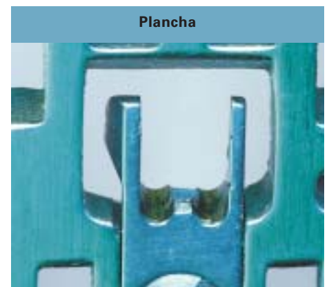
PLACA (PLANCHA) DE AGUJAS DAÑADA
