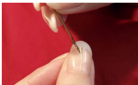
CONTROL DE LA PUNTA DE LA AGUJA: PASAR LA PUNTA DE LA AGUJA LIGERAMENTE POR ENCIMA DE LA UÑA DEL DEDO Y PRESTAR ATENCIÓN A SI SE PRODUCEN ARAÑAZOS.
